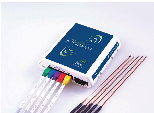
FIGURE 1.12 – Illustration des MOSFETs applicable à la peau du patient. A noter que la zone active du détecteur n'est contenue que dans la partie extrême de la tige.
