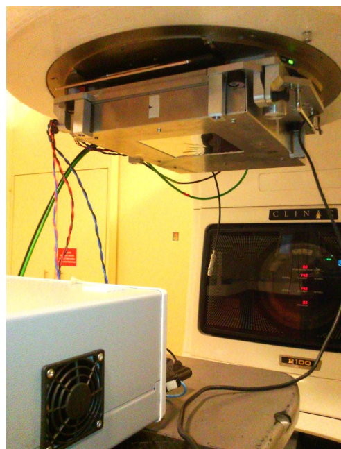
FIGURE 3.10 – Gauche : le système d'accroche développé par le service mécanique du LPSC. Droite : TraDeRa embarqué sur la tête du Clinac 2100 grâce au système d'accroche.
