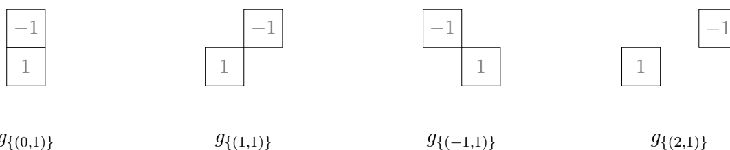
FIGURE 6.4 – Représentation de quatre fantômes élémentaires. Chaque fantôme est défini suivant une direction (p, q) appartenant à l'ensemble \{(0, 1), (1, 1), (-1, 1), (2, 1)\} . Par définition, la somme des valeurs de l'image suivant la direction du fantôme est nulle.
