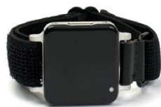
FIGURE B.4 – Centrale inertielle APDM ® Opal utilisée pour les expérimentations.
