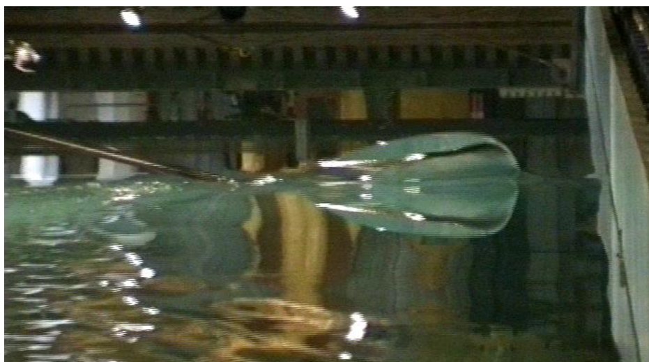
FIGURE 10.2 – Photographie d'un coup d'aviron simplifié effectué au bassin des carènes de l'ECN
