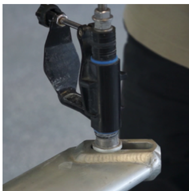
FIGURE 1.14 – Réglage de l'entraxe des dames de nage. Crédits Michel Picard et Didier Lereboulet (FFA).
