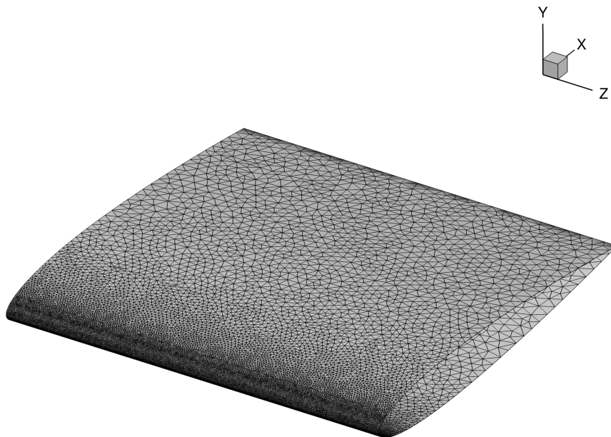
FIGURE 7.13. – Maillage surfacique utilisé par BLIM3D sur un profil d'aile NACA0012
