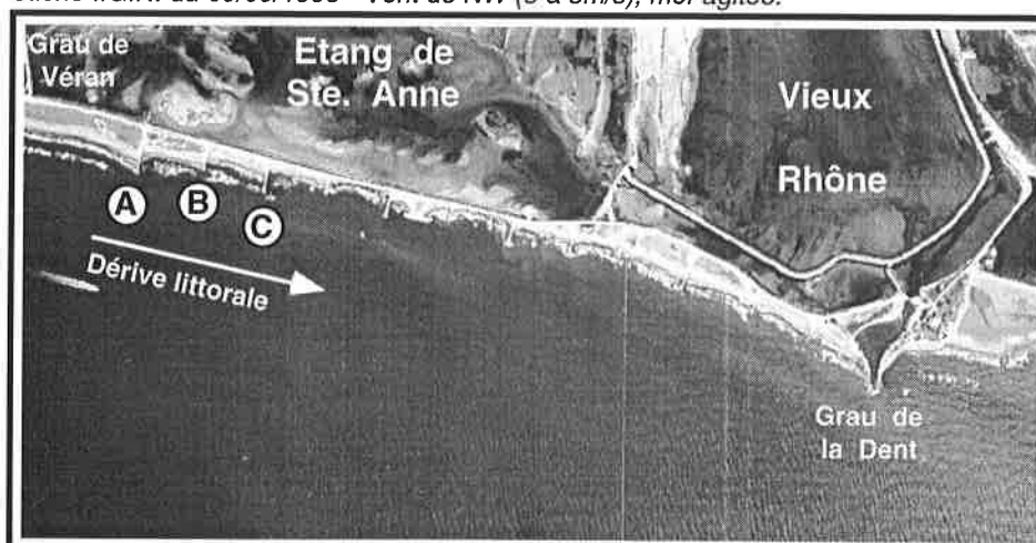
Photo 33. Mise en évidence des accumulations sédimentaires à l'Ouest de épis dans le secteur de l'étang de Ste. Anne (points A à C), indiquant le sens du transit sédimentaire longshore
