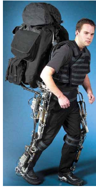
FIGURE 1.11 – BLEEX (États-Unis) [25] - Avec une charge élevée sur le dos de l'exosquelette, l'utilisateur doit contre-balancer le poids du sac vers l'avant.
