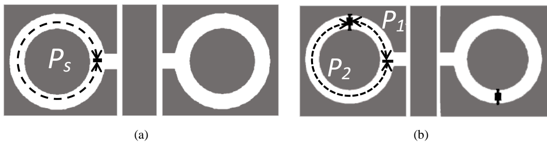
Figure IV. 26: Configuration du filtre coupe bande (a) et celle du filtre passe bande (b).
