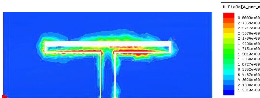
Figure III. 13: Distribution du courant de surface à 2.55 GHz de l'antenne de communication.
