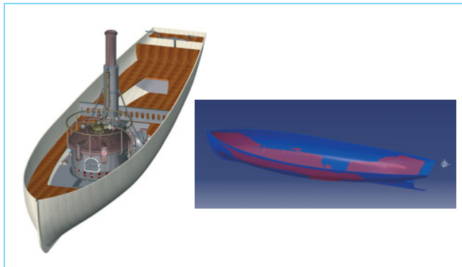
Figure 14 – Maquette numérique et comparaison avec le nuage de points (Crédits École Centrale de Nantes)
