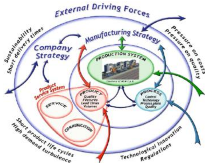
Figure 88 - Les dynamiques de l'environnement du système de production (Tolio, et al., 2010)
