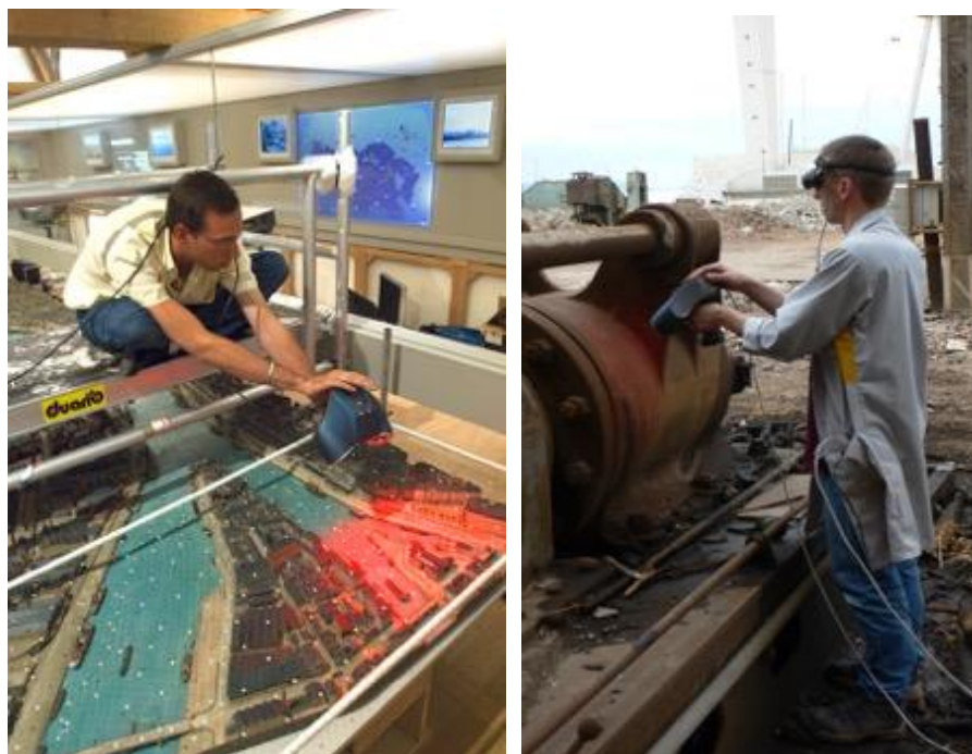
Figure 66 - Numérisation 3D par laser en musée (projet Nantes 1900) et sur ruine industrielle (La Ciotat)
