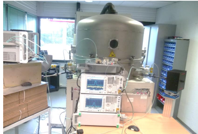
Banc de test en puissance sous vide
