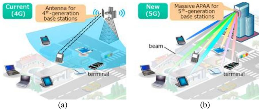
Fig. 114. Illustration de l'évolution technologique entre (a) la 4G et (b) la 5G [140].
