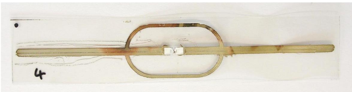
Fig. 6. Tag RFID réalisé par impression jet d'encre sur PET.
