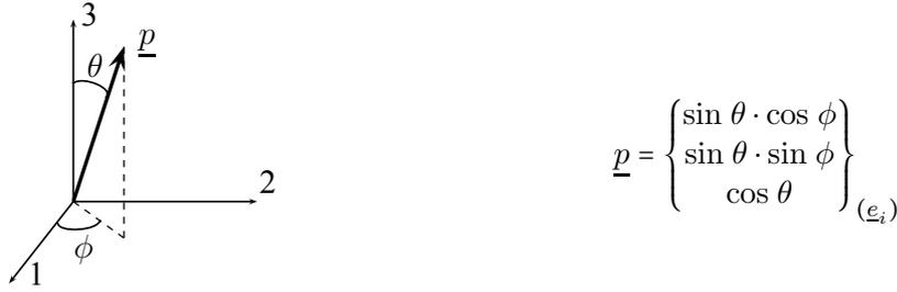
FIGURE 5.1 – Définition du vecteur d'orientation d'une fibre dans le repère global  $(\underline{e}_1, \underline{e}_2, \underline{e}_3)$ .
