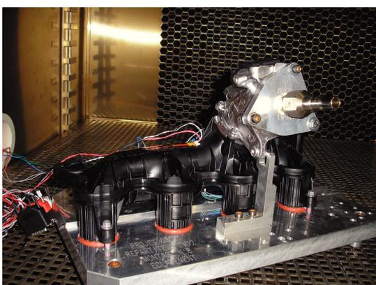
FIGURE 6.5 – Répartiteur d'air à l'admission dans l'enceinte thermique, monté sur le support en aluminium, et instrumenté avec deux jauges de déformation.
