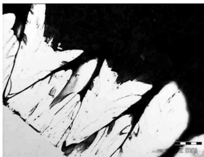
exemple de coupe de dépôt réalisé à \text{pH}=0,5 , 35\text{A}/\text{dm}^2 et 45^\circ\text{C} à partir d'un bain après 10\text{Ah}\cdot\text{L}^{-1} d'utilisation
