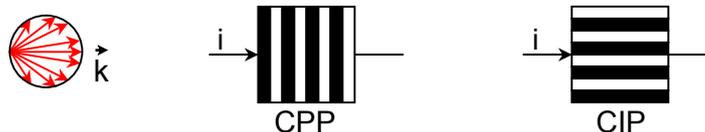
En géométrie CPP, la GMR est 3 à 4 fois plus élevée qu'en géométrie CIP et la décroissance de l'enveloppe de l'interaction entre couches est moins rapide: elle subsiste parfois jusqu'au micromètre contre la dizaine de nanomètres généralement affichée en géométrie CIP.
