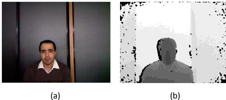
FIGURE 3.3: Exemple d'image 2D et demi. (a)Image de texture. (b) Image de profondeur correspondante, prise avec un Kinect. Le niveau de gris de chaque pixel représente la profondeur du point sur la scène.
