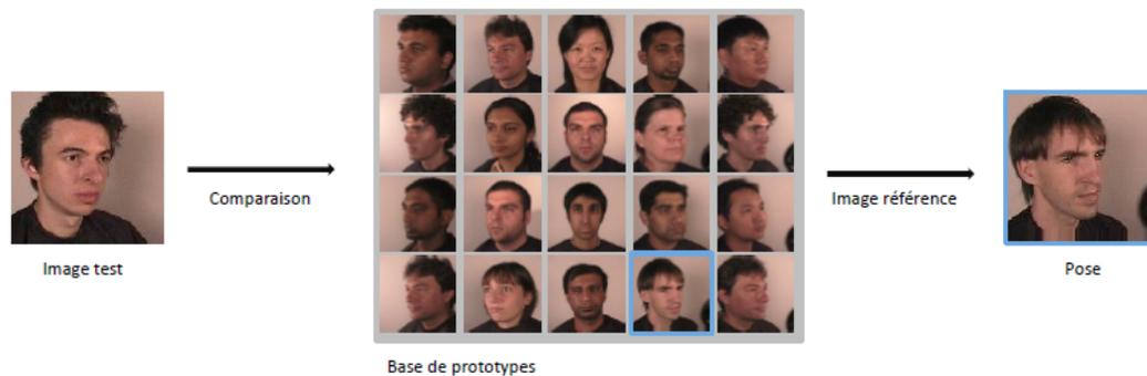
FIGURE 2.9: Les méthodes par comparaison de prototypes. La pose de l'image test est celle de l'image prototype la plus ressemblante.
