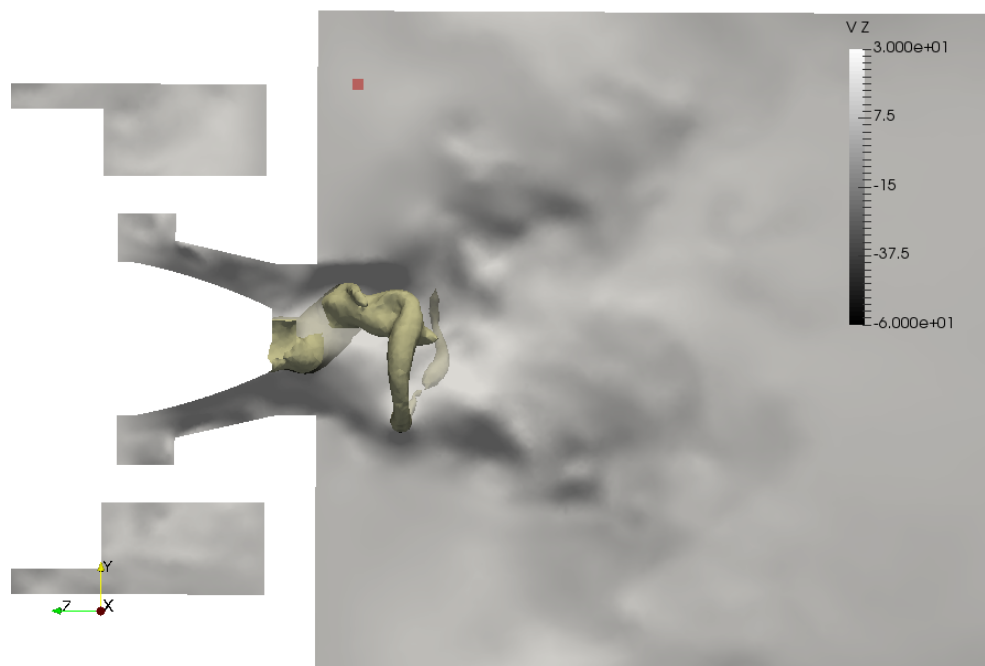
Figure 3.14 : Iso-contour de pression P = 99500\text{Pa} matérialisant le PVC sur champ de vitesse axiale instantanée. La position du capteur de pression est visualisée par un carré rouge
