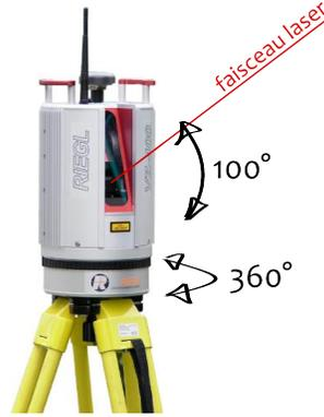
FIGURE 2.9 – Photo d'un laser à balayage angulaire Riegl. Son angle de balayage vertical est de  $100^\circ$ , et la rotation complète de sa base permet d'illuminer horizontalement à  $360^\circ$  [riegl.com].
