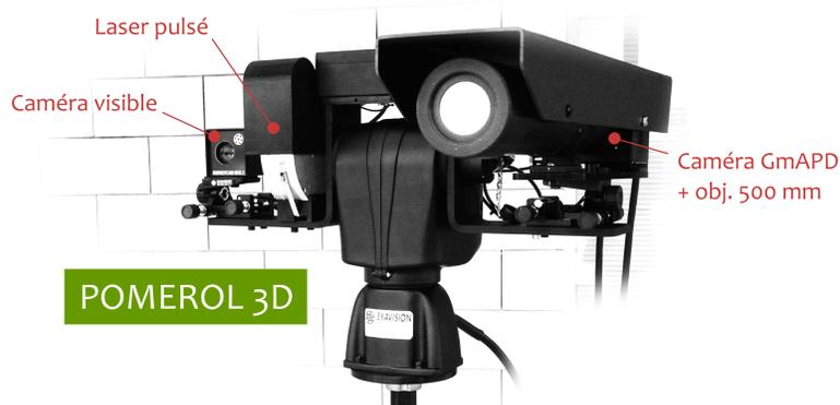
FIGURE 4.5 – Photo du dispositif expérimental POMEROL 3D utilisé pour les campagnes de mesures. Le laser, la caméra à plan focal 3D et la caméra contextuelle sont alignés sur une tourelle pilotable à distance par ordinateur. Positionnée sur un trépied pour les acquisitions statiques, elle peut être orientée dans toutes les directions.
