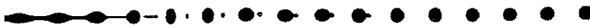
Figure 4-25 Brisure du jet en une goutte accompagnée d'un satellite sans phénomène de fusion réflexive. ( a = 220 \mu\text{m} , U_0 = 5,02 \text{ m/s} , f_{\text{tension}} = 1474 \text{ Hz} , V = 1200 \text{ Volts} , d_{1e} = 500 \mu\text{m} , \sigma = 58 \text{ mN/m} , \mu = 17 \text{ mPa s} , \rho = 1165 \text{ kg/m}^3 ).
