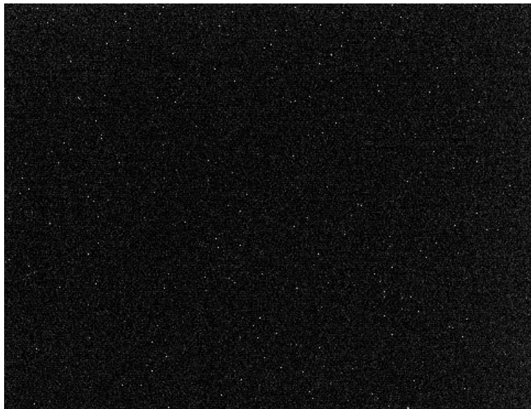
FIGURE 3.2 – Exemple d'image prise dans l'obscurité à une température de 252 K et un temps d'exposition de 20 s par un capteur dégradé. Les points blancs sont les pixels chauds [WBW + 02].
