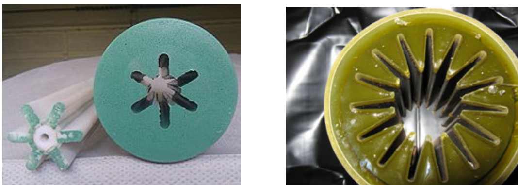
FIGURE 2. – Illustration de bloc de propergol avec une géométrie finocyl.
