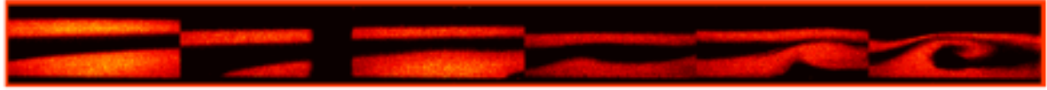
FIGURE 1.4. – Visualisation des structures tourbillonnaires de type VSP dans le montage VECLA avec la méthode PLIF (Planar Laser Induced Fluorescence) ; dans Ugurtas (2000).
