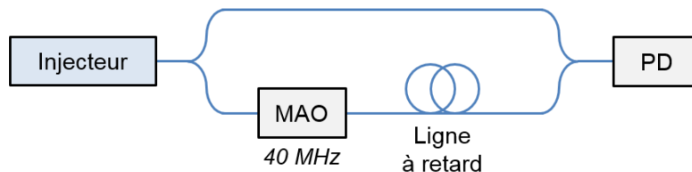
FIGURE 2.11 – Montage hétérodyne pour la mesure spectrale de l'injecteur.
