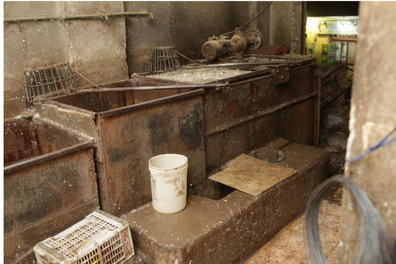
Fig. 31 : Ligne de lavage du plastique fabriquée par le père d'Emad (« khat ghasil », © David Degner / décembre 2014). Le plastique préalablement cassé en petits morceaux est transvasé de la droite vers la gauche dans des bacs de plus en plus propres. Le moteur visible en haut à droite permet de remuer l'eau du premier bac.
