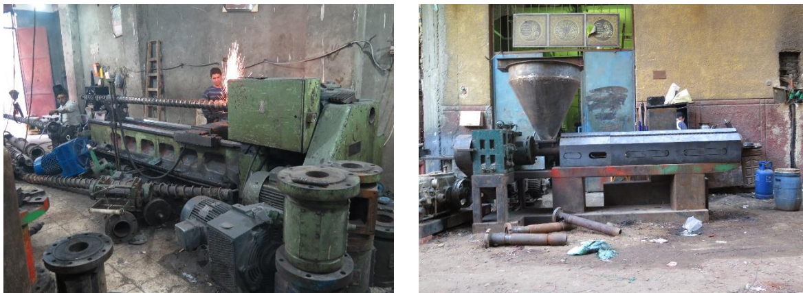
Fig. 34 : Atelier de fabrication de machines de recyclage à Shubra el-Kheima (ici des extrudeuses, © David Degner / décembre 2014)
