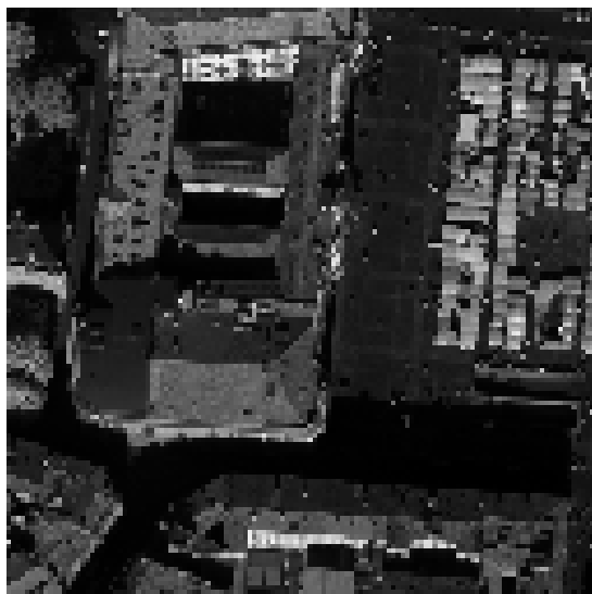
FIGURE 5.23 – Partie de la scène de Toulouse vue par un télescope avec une résolution spatiale de 1 mètre
