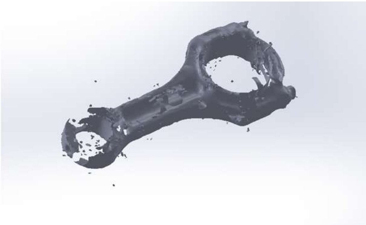
Figure A.11 – Numérisation 3D de la bielle assemblée (STL)
