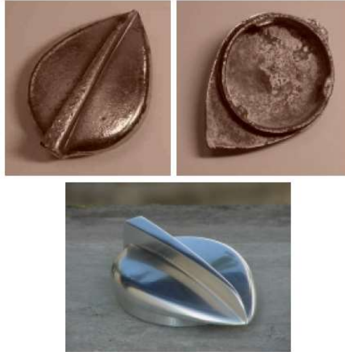
Figure 2.5 – Rétro-conception et refabrication d'un bouchon de radiateur (Delahaye 135) [Nartz & al. 02]
