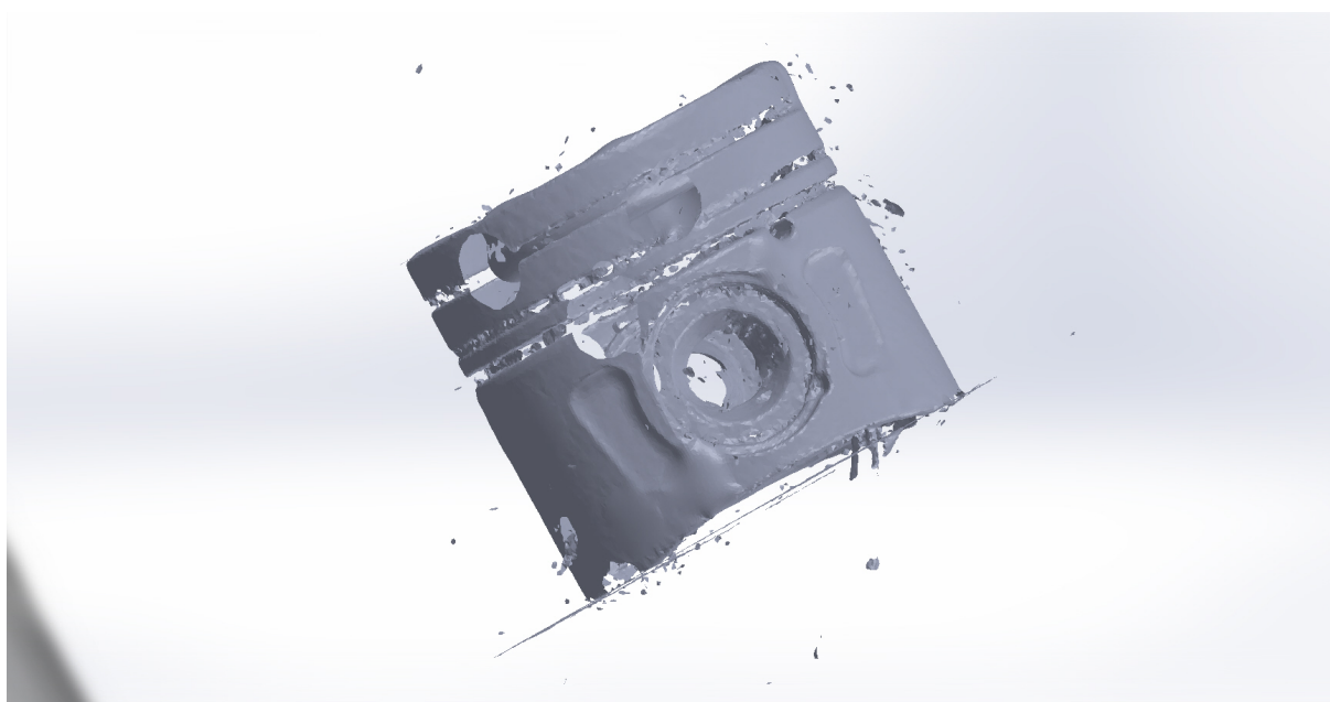
Figure A.13 – Numérisation 3D du piston (STL)
