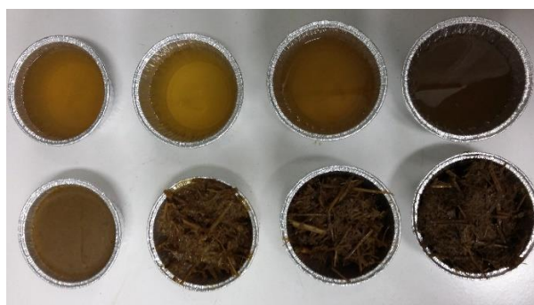
Figure 2-4 - Echantillons bruts et solubles dans des coupelles en aluminium pour l'analyse MS/MV.
