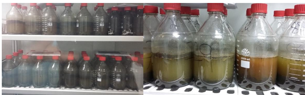
Figure 2-6 – Flacons des essais PBM hermétiquement fermés dans la pièce tempérée.
