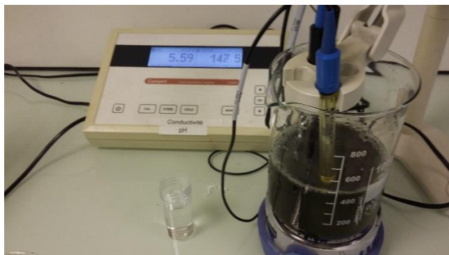
Figure 2-5 – Mesure du pH pour un échantillon soluble après lixiviation.
