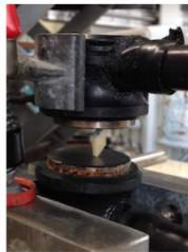
FIGURE 1.10 – Dispositif de spectroscopie à résonance ultrasonore.
