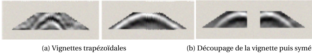
Figure 4.9: Exemple des éléments composant la base de données utilisée en entrée d'un réseau de neurones convolutionnel proposée par BIRKENFELD [2010].
