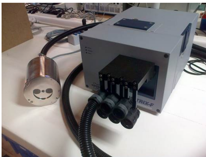
FIGURE 1.9 – Spectromètre Matrix-F Brüker utilisé pour l'acquisition des spectres par le Crittbois.
