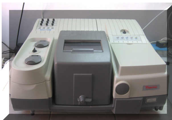
FIGURE 1.8 – Spectromètre Nicolet FTIR 8700. Les spectres analysés par le CRAN/ LCPME ont été acquis par ce dispositif.
