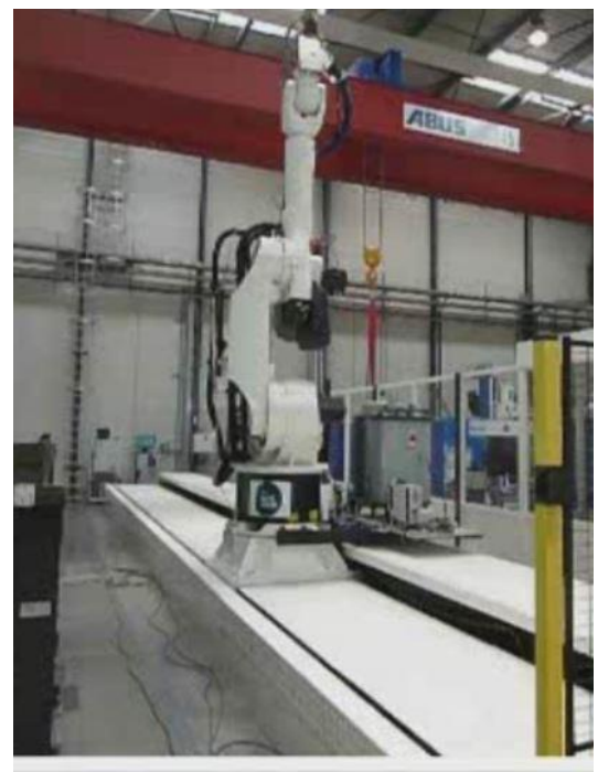
figure 99 : Cellule ROBOFIN : robot sur rail à l'IRT Jules Verne
