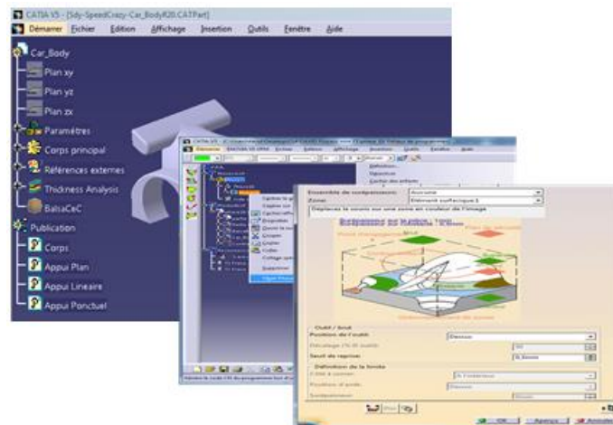
Figure 10: Mise en place d'un processus d'usinage automatisé dans CATIA via la publication
