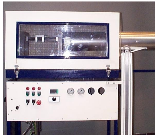
Figure 143 : chambre acoustique pour le réglage de la turbine
