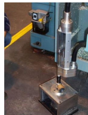
Figure 149 : UPA électrique en phase d'essais de perçage
