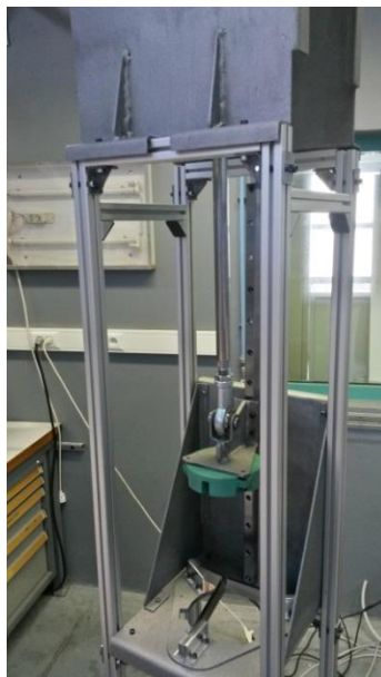
Figure 164 : système de découpe des soufflets par compression
