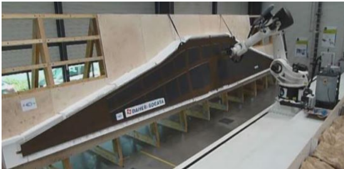
figure 89 : Mise en place de la voilure de DAHER pour son parachèvement
