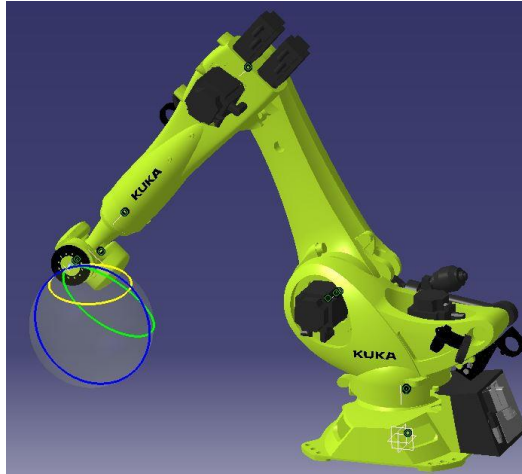
figure 135 : trajectoire à réaliser avec un BallBar
