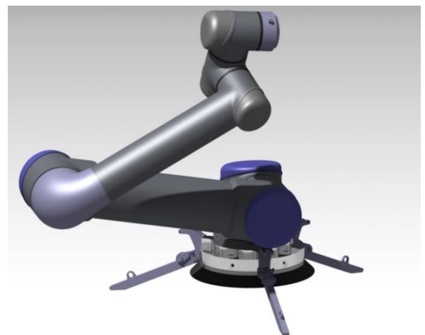
Figure 162 : principe d'accroche par ventouse du robot
