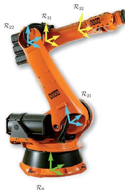
figure 2.3 – Positions des différents repères créés sur le robot
