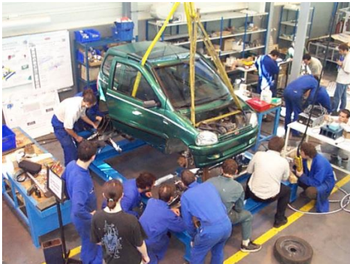
Figure 139: Mise en place de la voiture sur la machine de sollicitation
