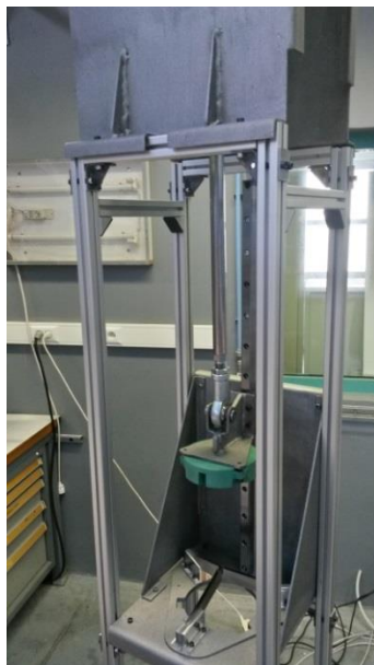
Figure 164 : système de découpe des soufflets par compression
