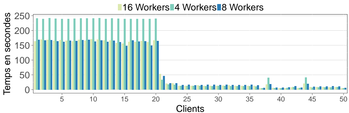
FIGURE A.8 – Temps local d’exécution par client avec l’approche Sans Délégation et la distribution statique des requêtes, sur 50 clients.
