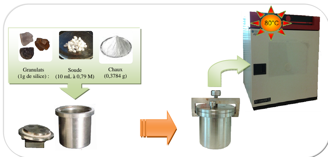
Figure II-5: Schéma de la préparation du milieu réactionnel pour l'étude de la réactivité du calcaire siliceux de Brunnen
