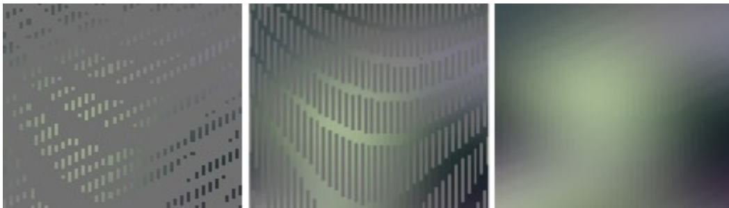
Fig. 4.5 – Rendu par éclaboussures avec différentes tailles de PSF (en pixels). À gauche : 0.5. Au milieu : 1.0. À droite : 2.0.
