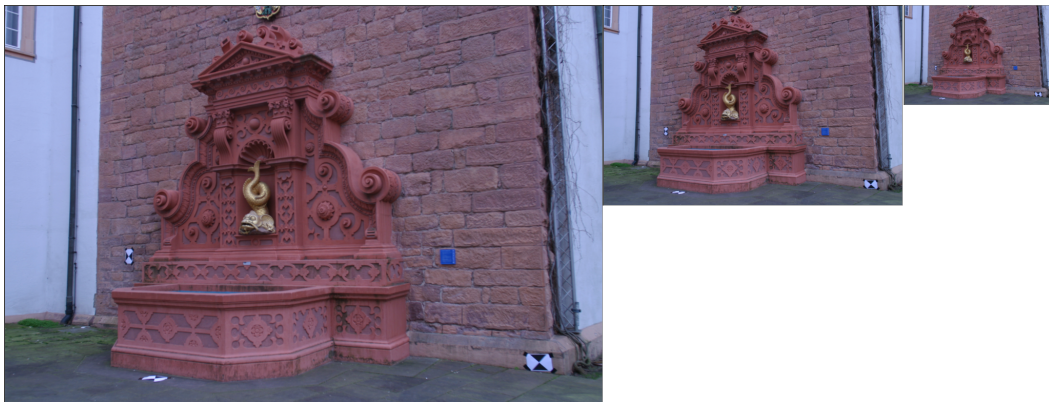
Fig. B.2 – Pyramide gaussienne, aussi appelée pyramide d'images, constituée ici de trois niveaux de résolution, n = 0 , n = 1 et n = 2 .
