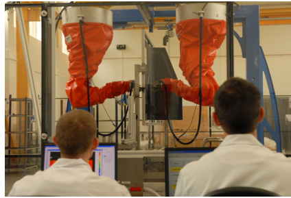
(b) analyse ultrasonore par C-scan jet d'eau
