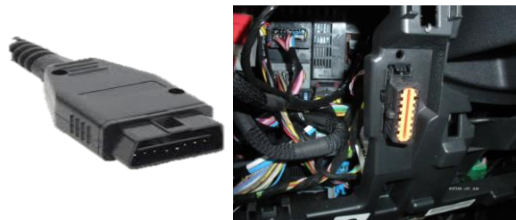
Figure 6 : Exemple d'adaptateur et de prise OBD véhicule
