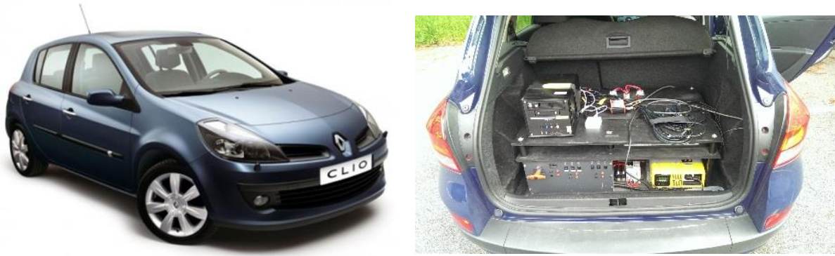
Figure 39 : Clio III du LIVIC et système de recueil de données du véhicule et des capteurs additionnels (radar et caméras).
