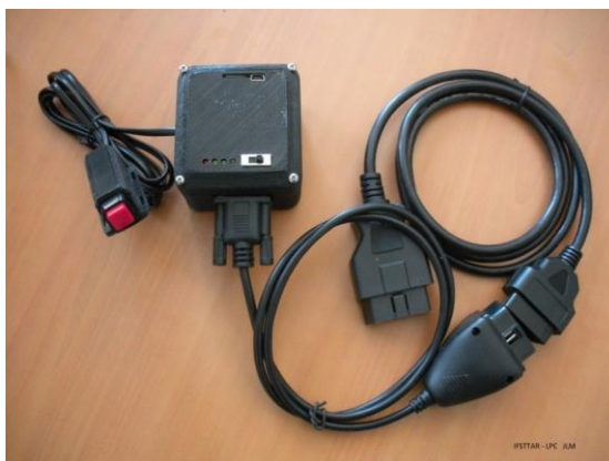
Figure 8 : Exemple d'instrumentation légère avec boîtier autonome avec capteurs intégrés et connexion à la prise OBD-II du véhicule (Projet MEDOC, Fondation MAIF)
