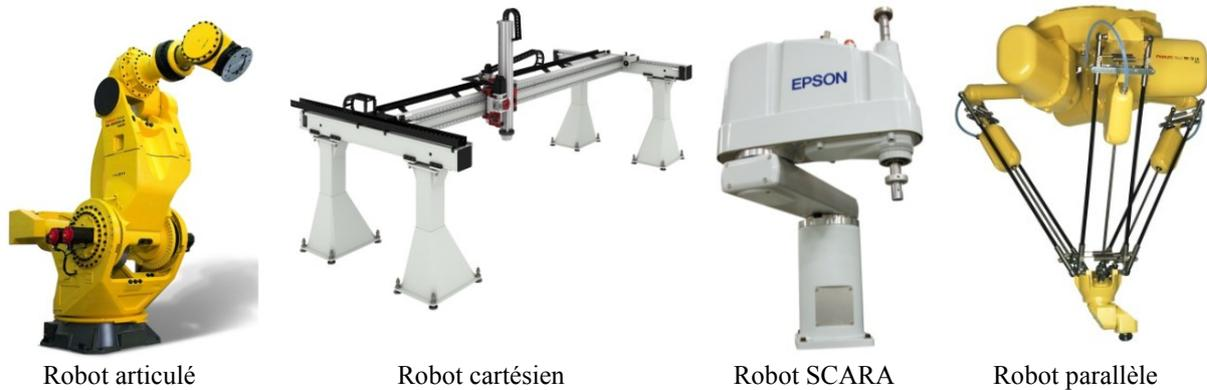
**Figure 3 : Types de robots industriels classés suivant leur structure mécanique (International Federation of Robotics, 2015)**
