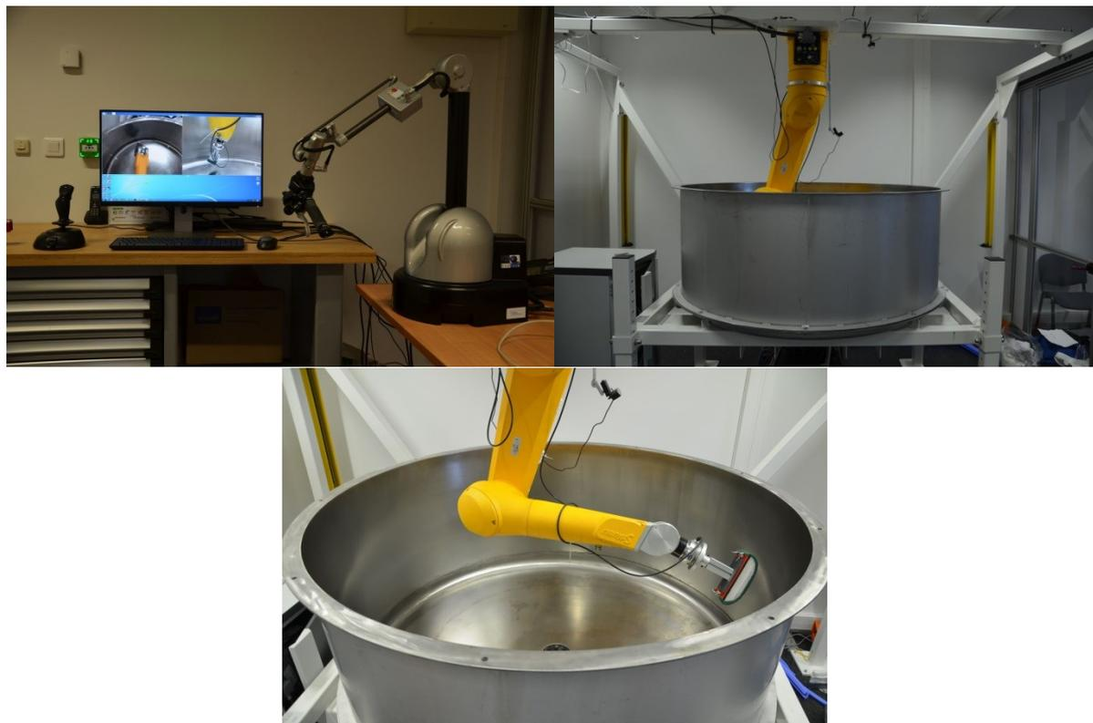
**Figure 69 : Photographies du prototype du système cobotique de nettoyage des cuves**
