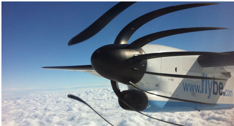
FIGURE 4.5 – L’effet rolling shutter dans le cas du mouvement d’un objet. Source : www.leblogphoto.net .
