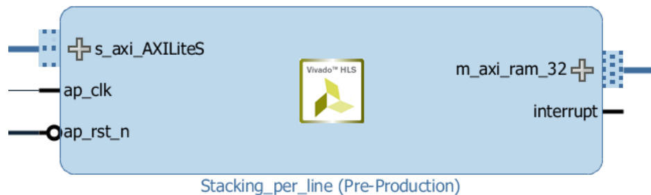
FIGURE A.5 – L’IP de stacking et son interface telle qu’elle dans VIVADO.
