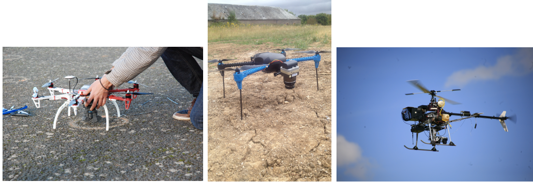
FIGURE 4.2 – Embarquement de la caméra légère de l’IGN sur plusieurs types de drones.
