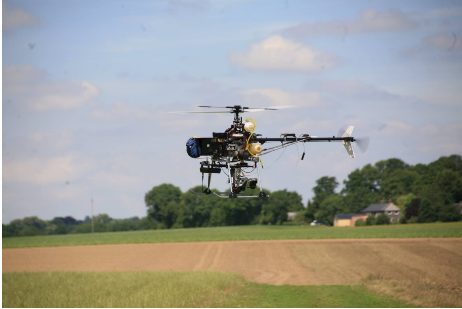
FIGURE 7.1 – le drone type Copter 1B développé par Wikydro et équipé d’une caméra légère de l’IGN pendant une des expériences réalisées.
