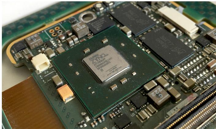
FIGURE 4.9 – Le SoC ZYNQ-7030 implanté dans la caméra.
