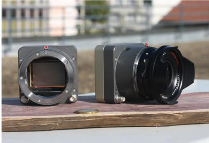
FIGURE 4.10 – La caméra de l’IGN sans et avec l’objectif.
