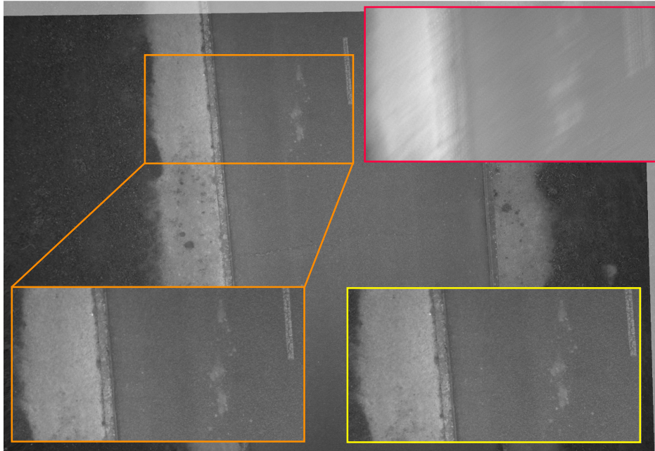
FIGURE 7.18 – Image empilée finale de la séquence 4. La zone orange représente un zoom de l'image finale empilée. La zone jaune représente la même zone dans première image de la séquence. La zone rouge représente la même zone dans la moyenne de 10 images non recalées.
