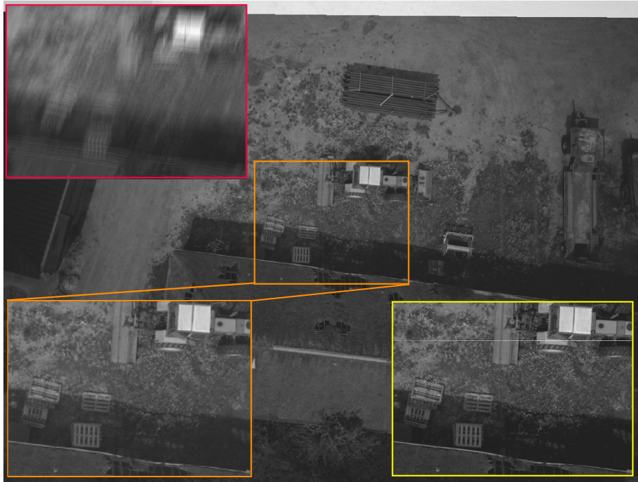
FIGURE 7.13 – Image empilée finale de la séquence 3. La zone orange représente un zoom de l'image finale empilée. La zone jaune représente la même zone dans première image de la séquence. La zone rouge représente la même zone dans la moyenne de 10 images non recalées.
