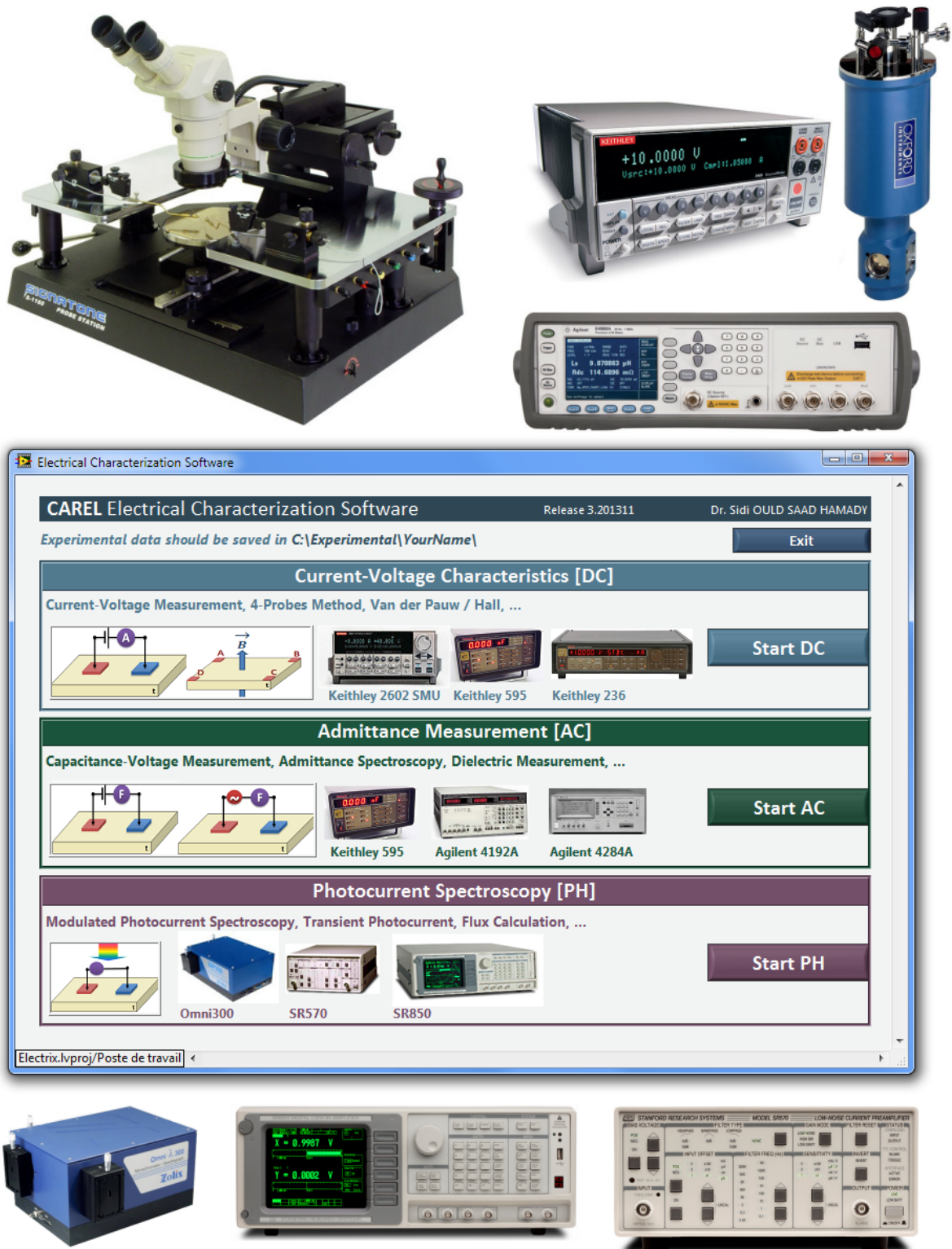
FIGURE 1.6 – Quelques éléments de la plateforme de caractérisation électrique CAREL avec la station sous pointes, une unité électrique double pour les mesures van der Pauw / Hall et les relevés courant-tension, le cryostat à azote liquide, l'analyseur d'impédance, le monochromateur, la détection synchrone et le pré-amplificateur de courant pour le banc de photocourant, et l'interface du module logiciel qui centralise et contrôle l'accès à tous les bancs de la plateforme.
