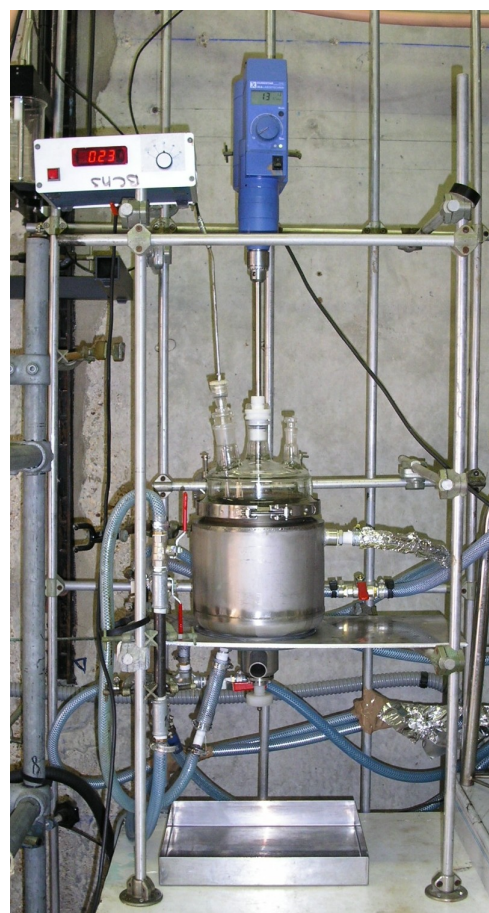
(b) cristallisation en voie fondue ( prilling ) de l'ammonium dinitramide dans une cuve de 2,5 L
