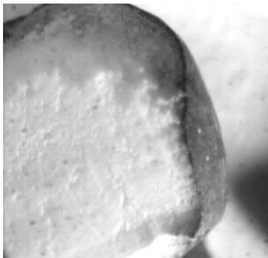
FIGURE 1.20 – Photographie d'une coupe de grain de catalyseur pour l'OVH : alumine en blanc ; dépôt de cérium et ruthénium en noir sur la surface
