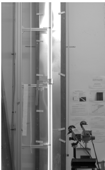
FIGURE 1.1 – Dispositif expérimental pour l'étude du mélange gravitaire : au milieu le tube vertical (dont on voit sur cette photographie environ 2,5 m) ; au centre la vanne à guillotine et sa manœuvre sur la gauche ; au fond l'éclairage ; sur la gauche le support vertical du tube ; en bas à droite les deux caméras
