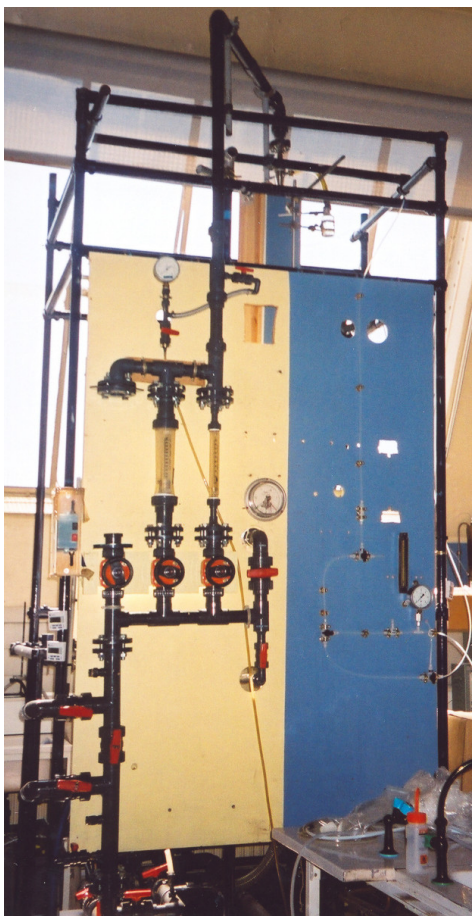
(a) panneau de commande manuel : à gauche en jaune pour le liquide; à droite en bleu pour le gaz
