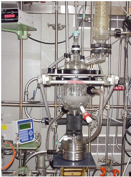
(a) cuve de laboratoire d'1 L (réfractomètre en fond de cuve)
