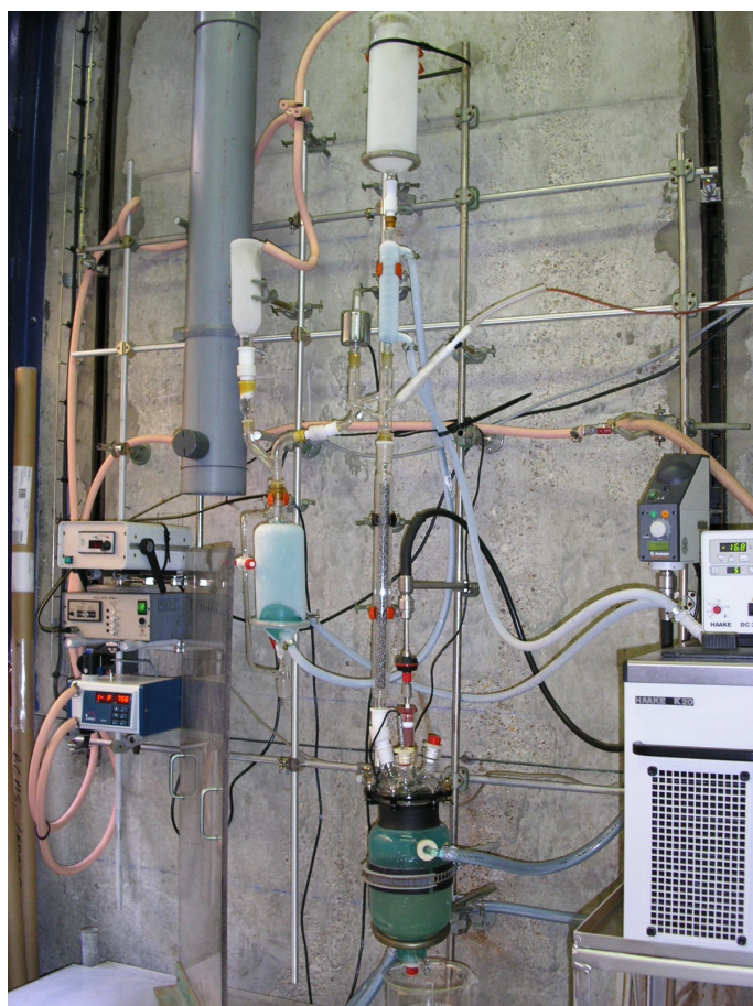
(a) cristallisation du perchlorate d'ammonium par évaporation dans une cuve de 5 L
