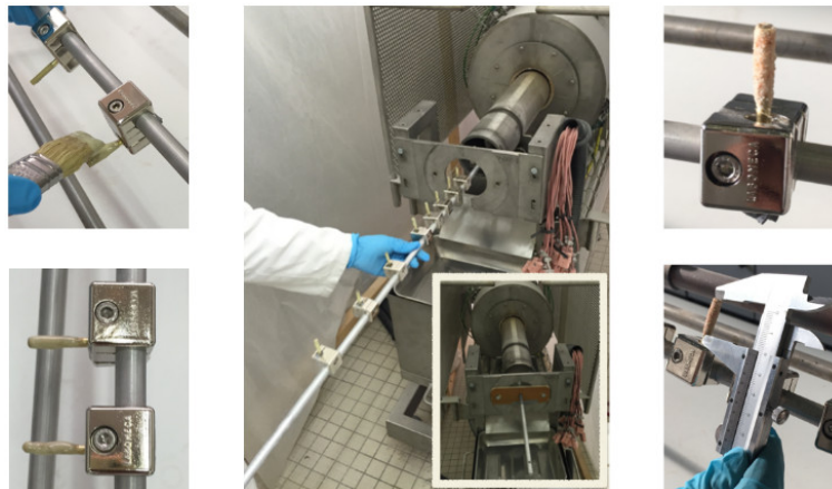
FIGURE 2.23 – Procédure de mesure du profil de chargement du four tournant pilote
