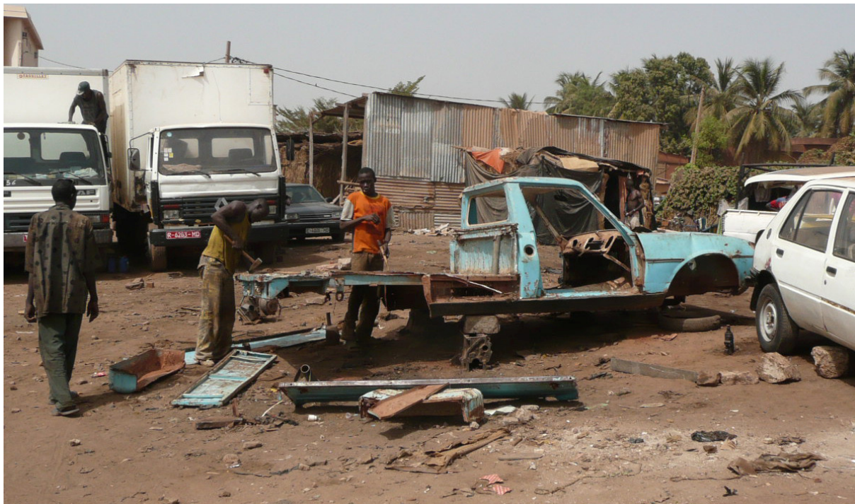
Figure 172 - Récupération de l'acier sur des épaves de voitures.
