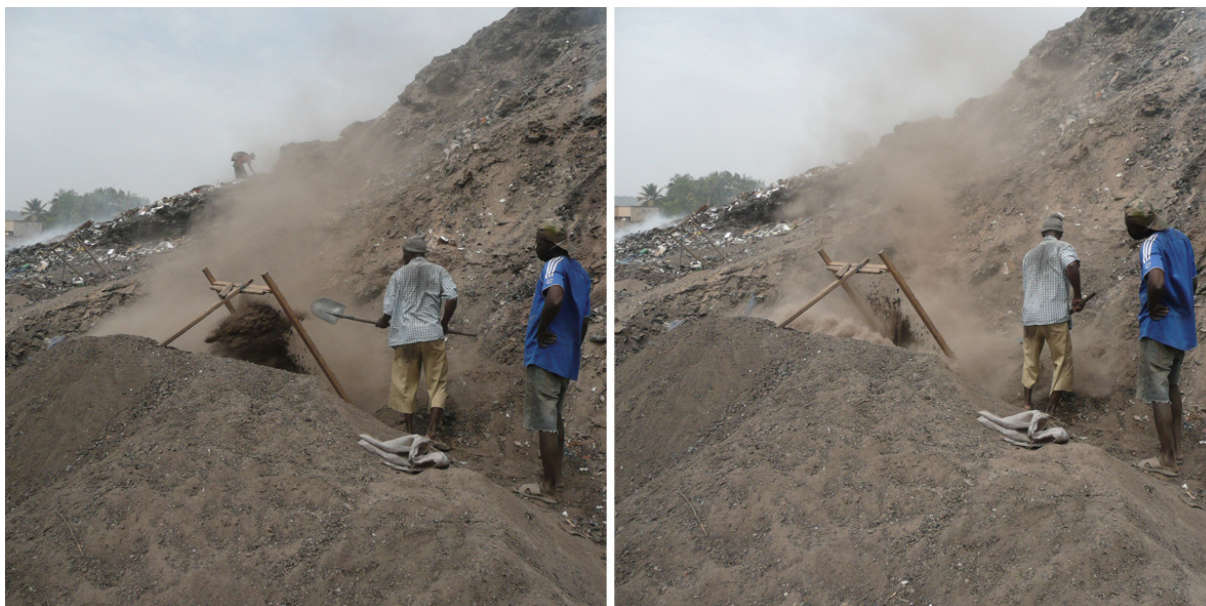
Figure 169 - Tamisage de la matière extraite au pied de la montagne de déchets
