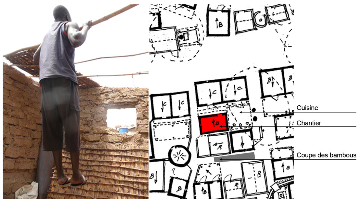
Figure 85 - test de flexion des premiers bambous
