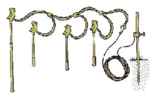
La vérification et la mise à la terre et en court-circuit peuvent se faire depuis le sol avec des « perches nevers ». Dans tous les cas, il est nécessaire de trouver un bon endroit pour poser la mise à la terre afin de ne pas entraver la réalisation des travaux...
