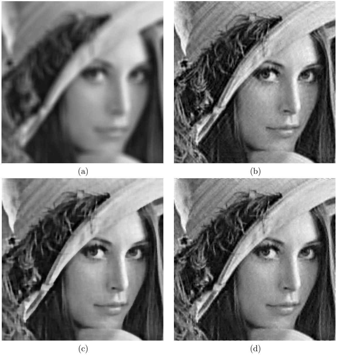
FIGURE 5.3 – (a) Image floue, images reconstruites par (b) SURE-LET [PBBC09] (c) TV [ZFR15b] (d) l'approche proposée.
