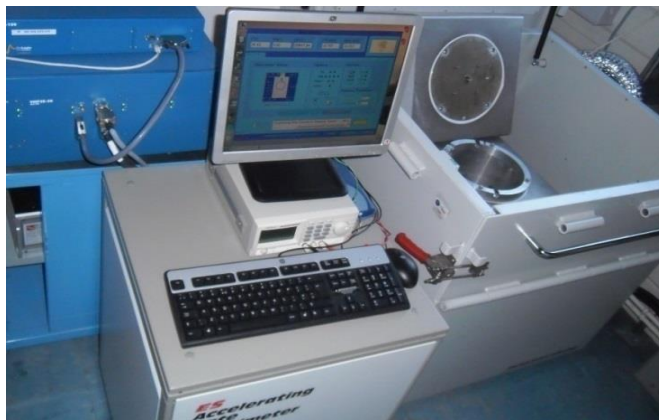
(a) Vue d'ensemble du calorimètre adiabatique de la plateforme CaCySSÉE
