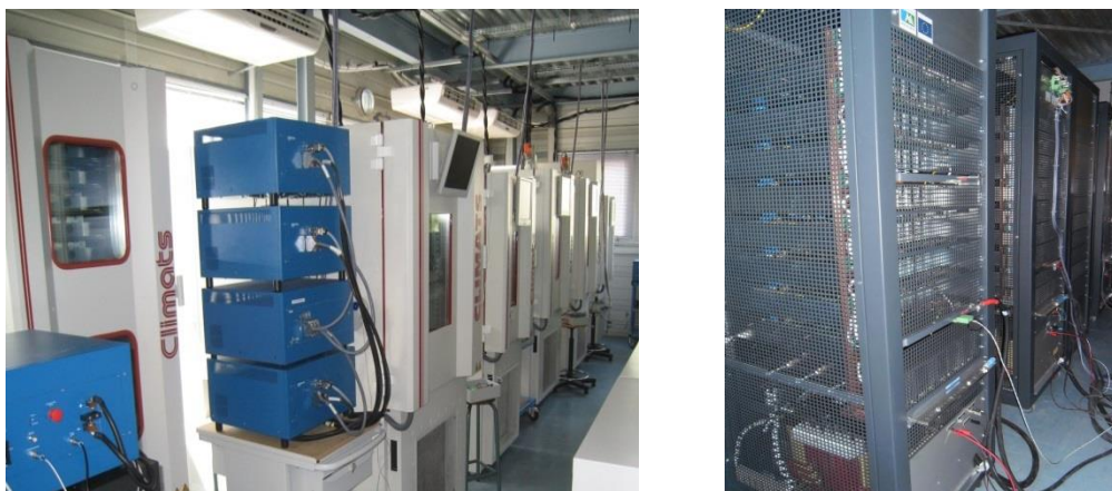
(a) Enceintes climatiques et stations électrochimiques (b) Bancs de cyclage fort courant
