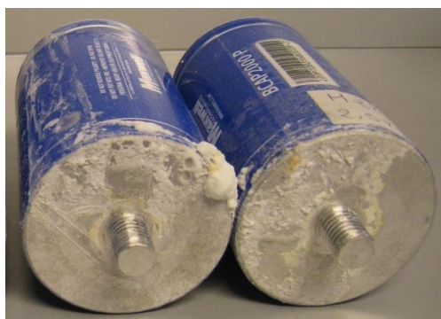
(a) Fuite d'électrolyte
