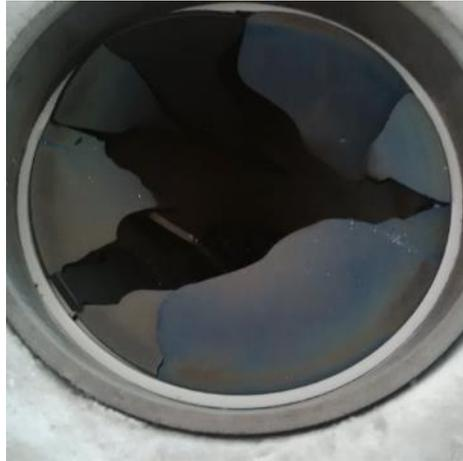
Figure 81 : Plaque de SiC après le premier essai de mise en chauffe du réacteur en configuration indirecte
