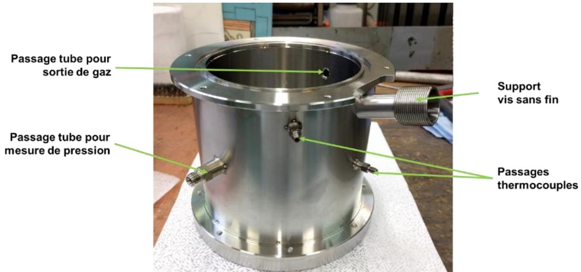
Figure 83 : Corps du réacteur avec bride inférieure
