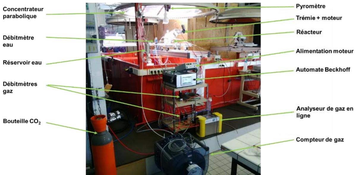
Figure 84 : Montage complet du banc d'expérimentation REACSOL
