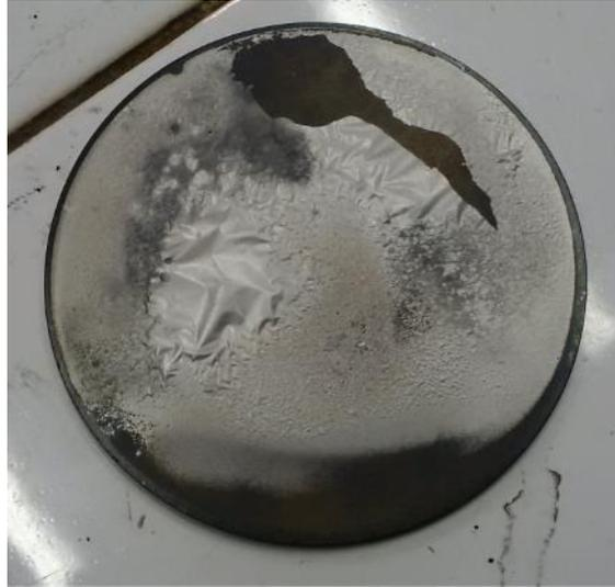
Figure 122 : Plaque émettrice en SiC après essais de gazéification à l'eau
