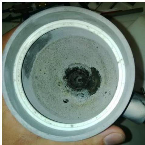
Figure 100 : Photo de la cavité du réacteur après 3 essais consécutifs à 1400°C
