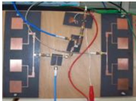
Figure 2: Système Doppler modulaire pour les TP elec 4
